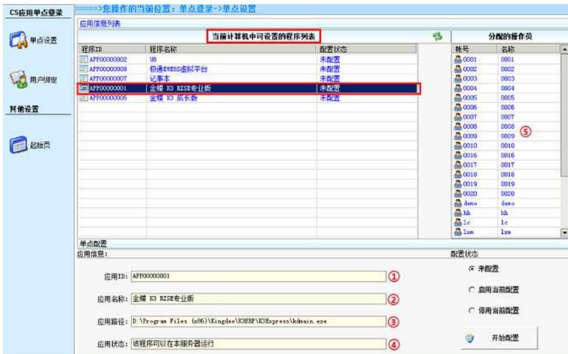
注：当前计算机中可设置的程序列表是指在极通控制台发布的所有程序。
